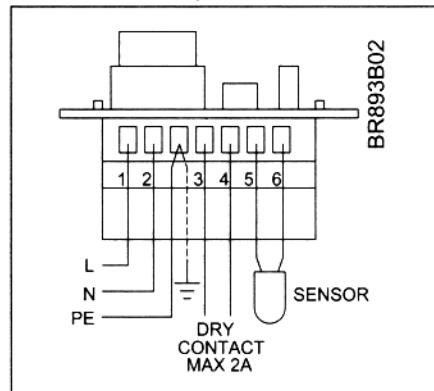
Fig. 2 - with built-in sensor / avec capteur incorporé
